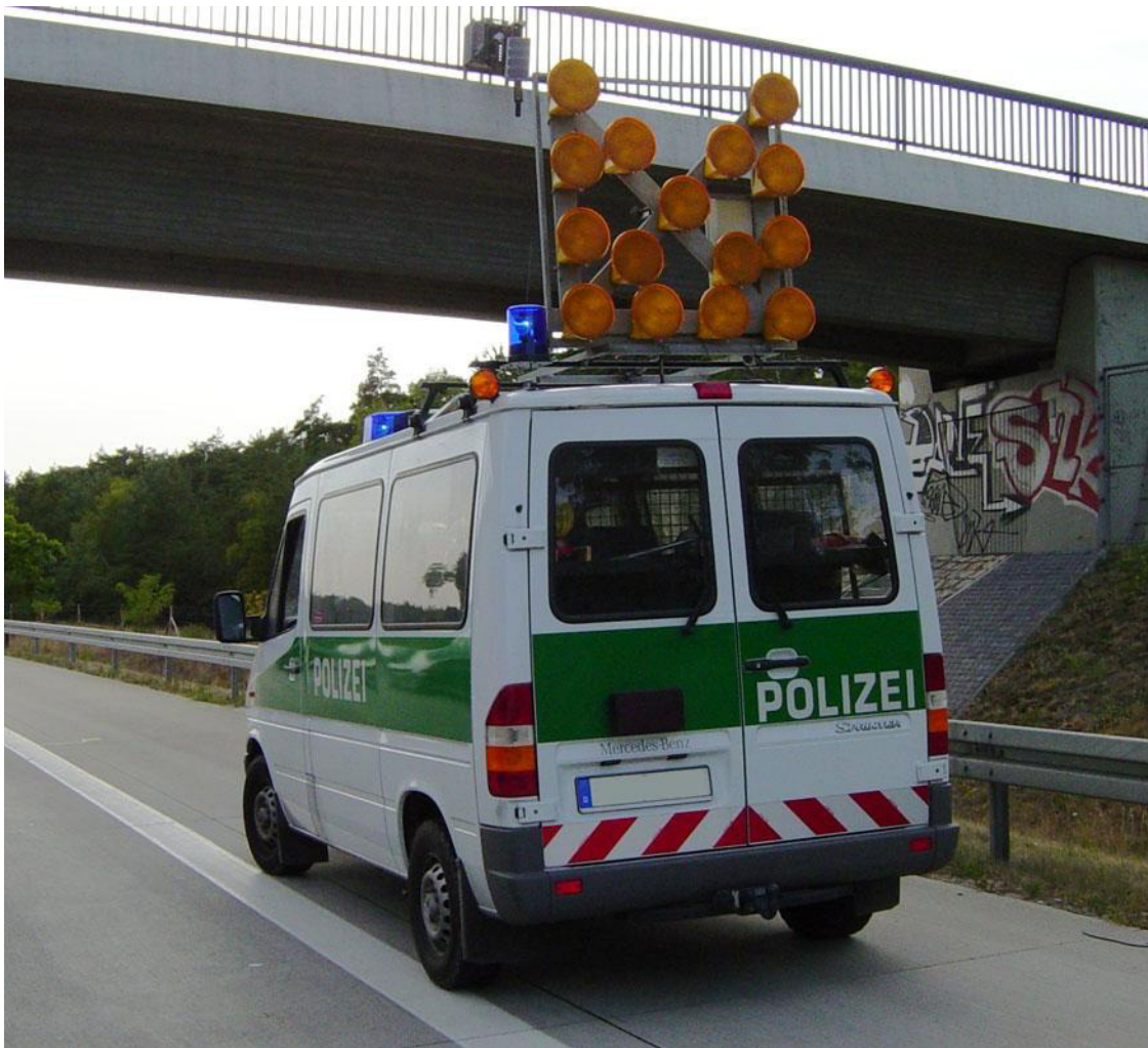
Abbildung 46: Sicherungskraftwagen der Polizei mit Blinkpfeil
