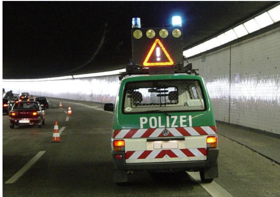
Abbildung 75: Sicherungskraftwagen der Polizei mit LED-Warnschild
