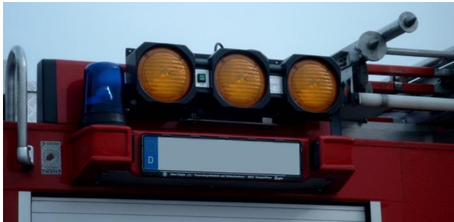
Abbildung 43: TRI-Blitz als Verkehrswarmanlage (Quelle: Verfasser)
