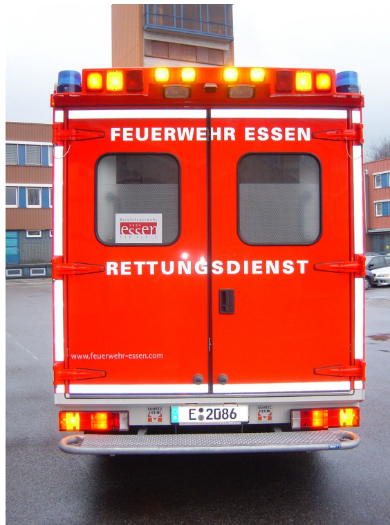
Abbildung 42: Rettungswagen mit Verkehrswarneinrichtung in der Heckkonsole (Quelle: Feuerwehr Essen)
