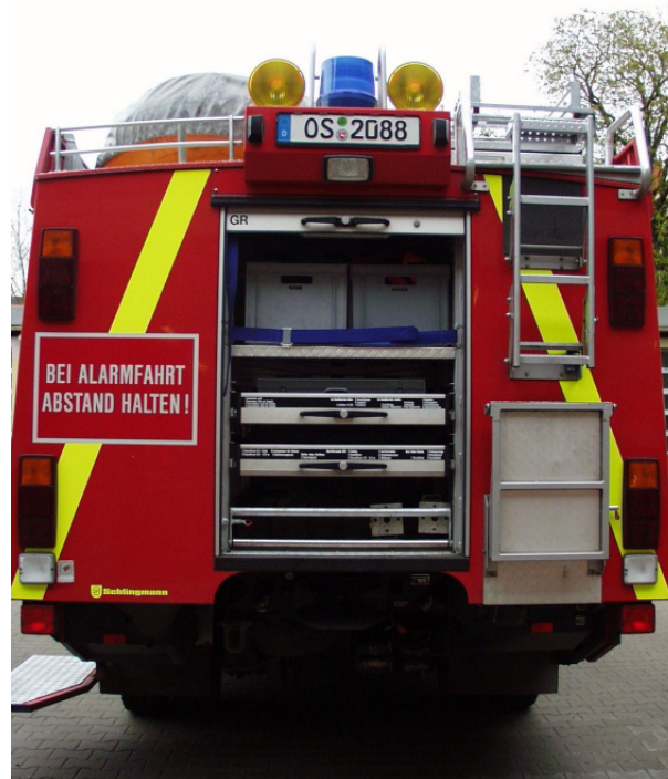
Abbildung 45: Rüstwagen mit Weitwarnleuchten (Quelle: Südmersen, Osnabrück)
