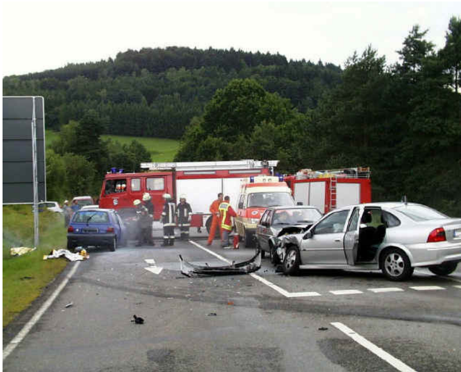
Abbildung 53: Quer zur Fahrbahn aufgestelltes Löschfahrzeug (Quelle: unbekannt)
