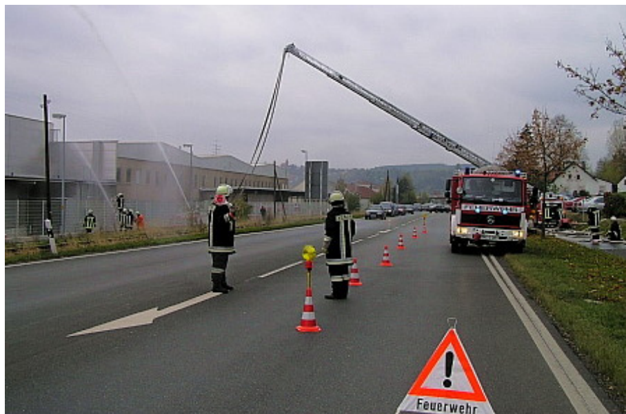
Abbildung 69: Drehleiter als Schlauchüberführung (Quelle: Feuerwehr Kornach)
