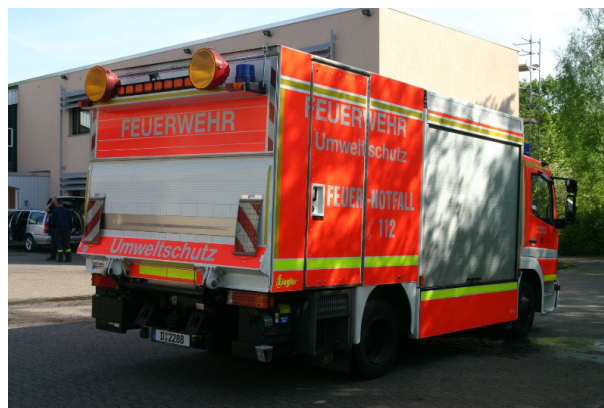
Abbildung 44: Gerätewagen – Öl mit Weitwarnleuchten und Verkehrswarnanlage (Quelle: Truckenmüller, Düsseldorf)
