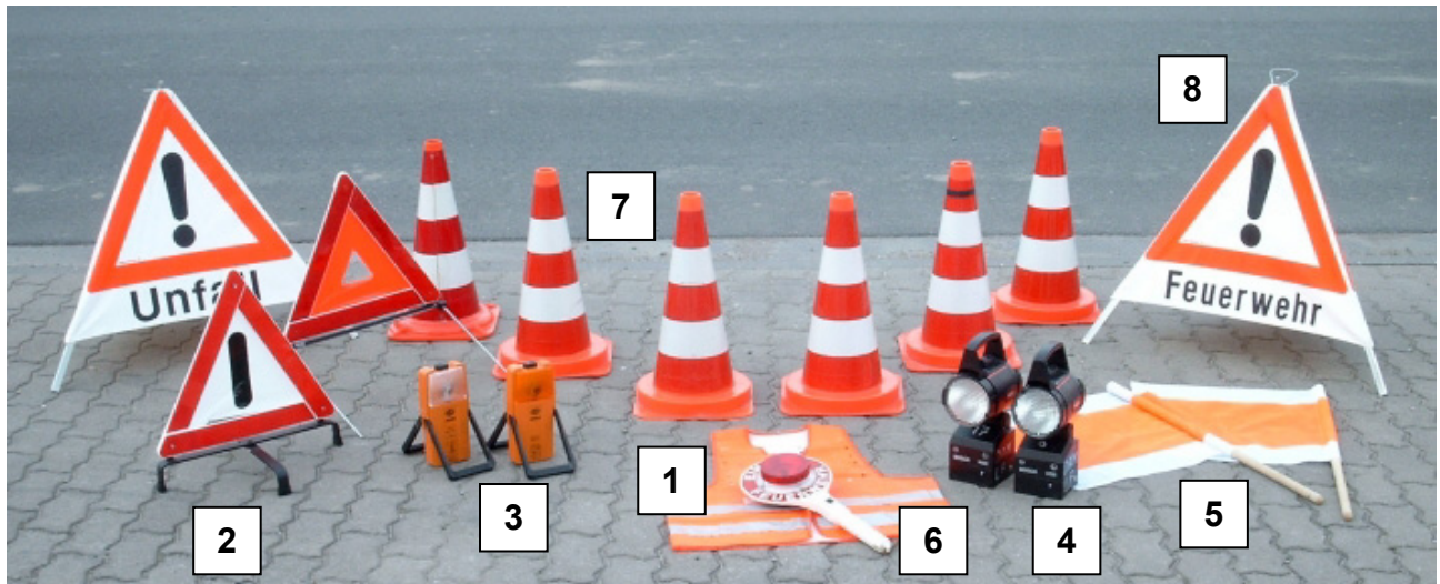
Abbildung 25: Warngeräte: 1: Warnweste; 2: Warndreieck; 3: Warnleuchte; 4: Handscheinwerfer; 5: Warnfahnen; 6: Winkerkelle; 7: Leitkegel – Höhe 500 mm; 8: Faltsignal – Schenkellänge 600 mm
