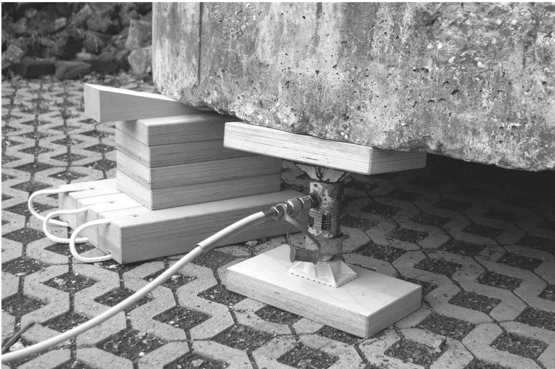
Die Stempel der Hydraulikzylinder können mit Verlängerungsrohren verlängert werden.
