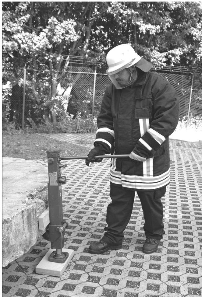
1 Die Fußplatte der Winde wird in der Regel auf eine Fußlagerplatte (Zubehör)
